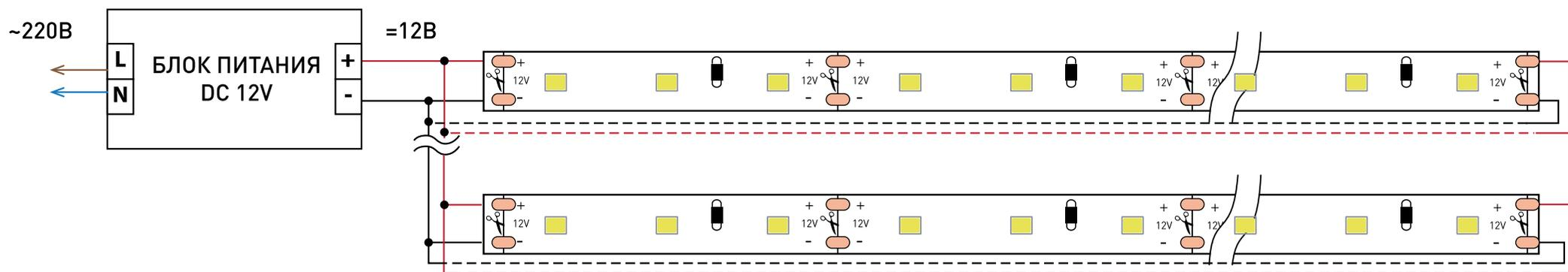
4. Ленту можно разрезать на отрезки с минимальным количеством светодиодов. Каждая линия отреза отмечена черной полоской и по обе стороны имеет две пары контактных площадок для дальнейшего соединения.
