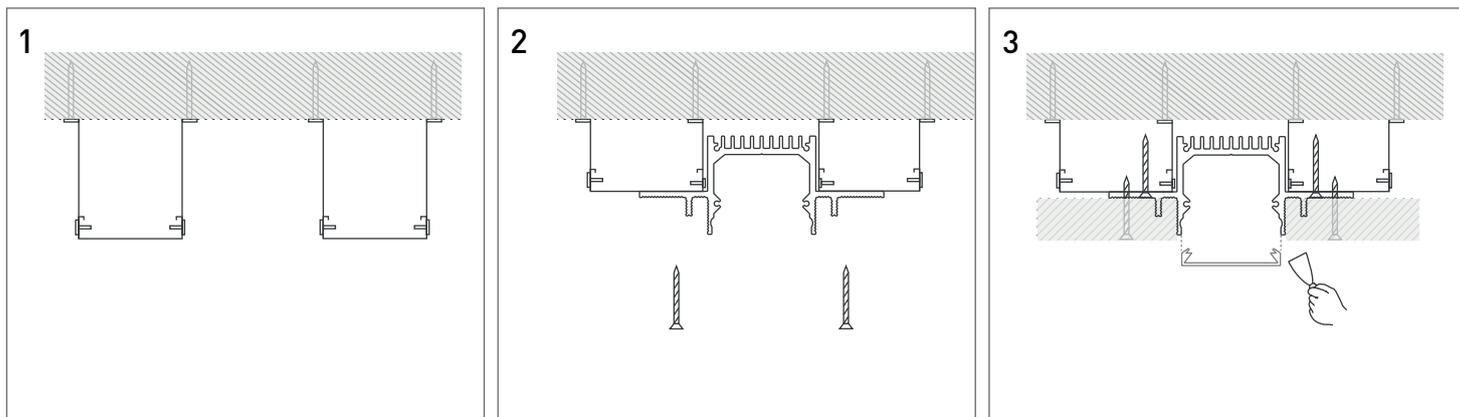
1. Установите конструкционный профиль для гипсокартона с отступом 37мм.
